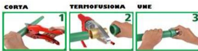
El sistema **IUSAPLUS®** es compatible con todos los sistemas hidráulicos actuales como: Cobre, Acero Galvanizado y Acero Negro, CPVC y Multicapa en donde la transición de unión se hace con conectores rectos o angulares 90° con rosca hembra o macho NPT colocando siempre cinta teflón en las roscas macho como sellador de cuerdas.
